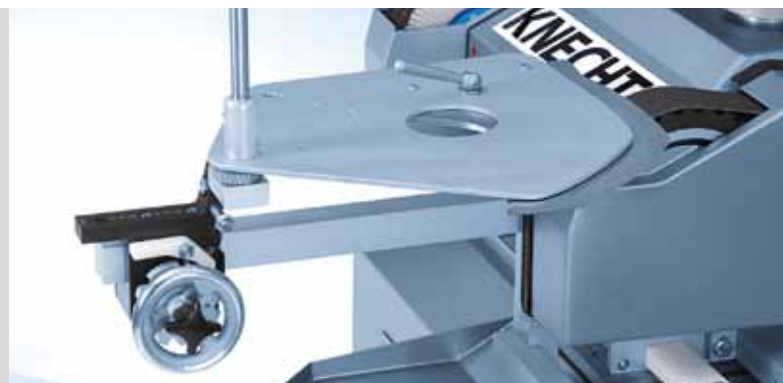
Ленточное шлифовальное устройство HV 261 для серповидных куттерных ножей
